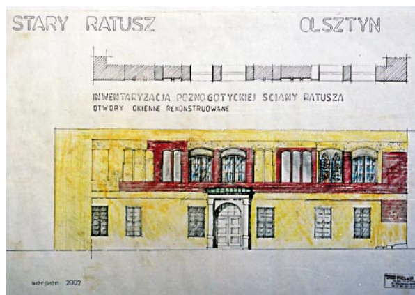
Olsztyn, Stary Ratusz, elewacja południowa, próba rekonstrukcji, w której proponowano ukazanie w formie odkrytki odsłoniętego wystroju, przy czym pozostałe elewacje pokrywałby tynk. Rysunek wykonał Dariusz Chodkowski, wrzesień 2002 r. Fot. W. Chodkowska
