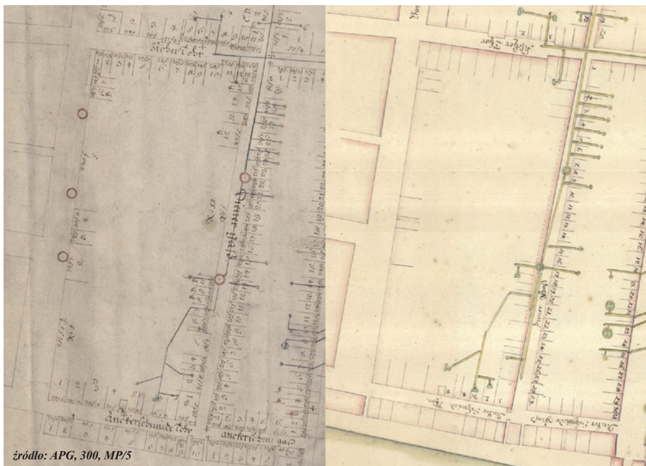
Ryc. 9. Wodociągowa sieć grawitacyjna w obrębie kwartału objętego badaniami, ok. 1700 i w 1717 r. Archiwum Państwowe w Gdańsku Fig. 9. Gravity water supply network within the quarter covered by the research, around 1700 and in 1717. State Archives in Gdańsk
