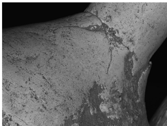
Fot. 5. Nowa Huta-Mogiła, stan. 55. Obraz SEM powierzchni szpili z ob. 86 (połączenie główki i trzpienia), powiększenie 50x
