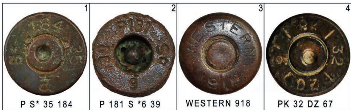
Ryc. 4.55. Żanęcin, stanowisko 10. Dna łusek po nabojach 7,92 × 57 mm do karabinu Mauser odkryte na stanowisku Fig. 4.55. Żanęcin, site 10. 7.92 × 57 mm Mauser rifle case bases discovered at the site
