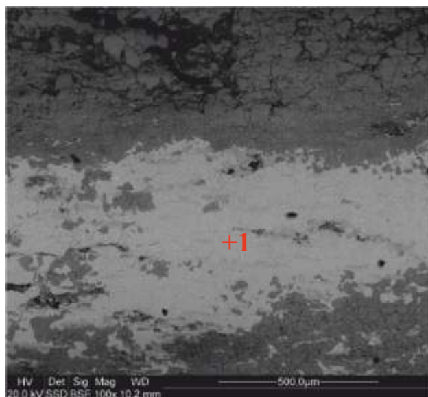
Ryc. 69. Obraz z mikroskopu elektronowego dla skręta z Falejówki (kat. I.33) wraz z analizą składu chemicznego w mikroobszarach (Tab. 12). Oprac. M. Wardas-Lasoń, A. Garbacz-Klempka
