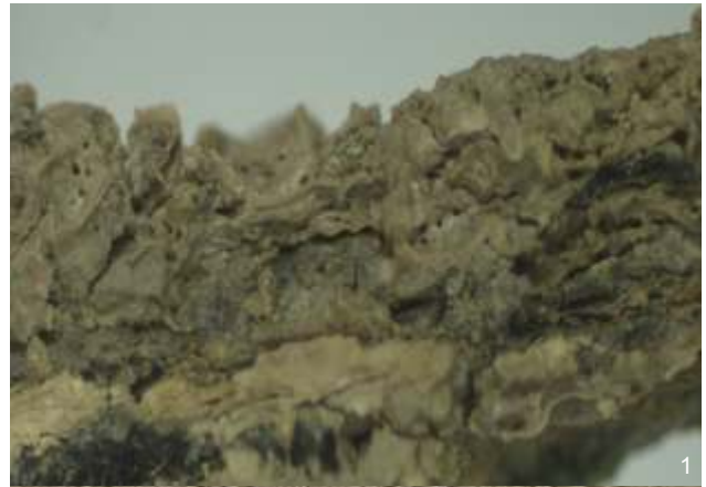
Ryc. 130. Obraz próbki P/64. Widoczne zniszczenie powierzchni materiału oraz obecność licznych kryształów. Pomimo tego w skórze widoczne są małe otworki-pory charakterystyczne dla rozmieszczenia włosów w skórze. Fot. P. Kuroпка Fig. 130. Image of Sample P/64. Visible destruction of the material's surface and the presence of numerous crystals. In spite of this, small opening-pores which are characteristic of hair distribution in skin are visible in leather. Photo P. Kuroпка
