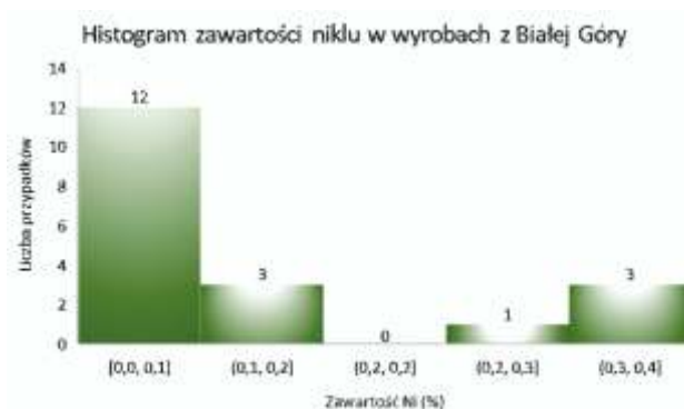
Ryc. 113. Histogram zawartości niklu we wszystkich badanych wyrobach z Sanoka (Białej Góry). Oprac. A. Garbacz-Klempka Fig. 113. Histogram of the nickel contents in all the examined artefacts from Sanok (Biała Góra). Processing A. Garbacz-Klempka
