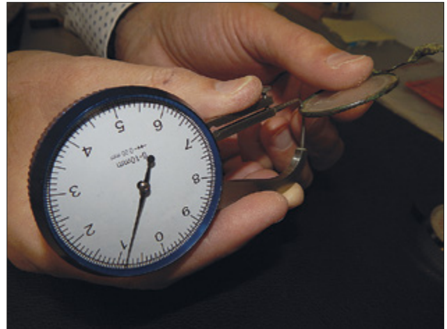
Ryc. 4. Pomiar bazy zewnętrznej soczewki lewej. Fot. P. Stępniewski
