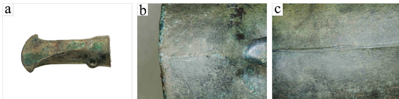
Ryc. 6. Brudzyń (stanowisko 64), pow. żniński. Obraz makroskopowy siekierki tulejkowatej Br_2 (a). Widoczna zalewka, będąca efektem nieszczelności formy odlewniczej (b). W górnej partii tulei zgrupowane pojedyncze porowatości, powstałe zapewne w wyniku reakcji ciekłego metalu z tworzywem rdzenia (c). Fot. P. Jurecki
