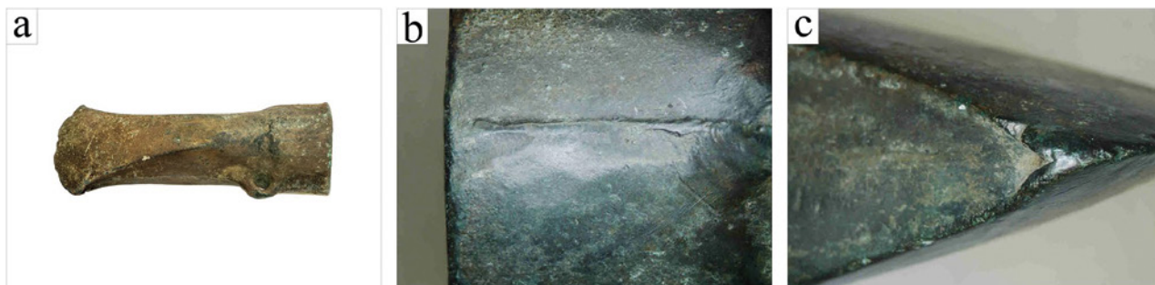
Ryc. 8. Brudzyń (stanowisko 64), pow. żniński. Obraz makroskopowy siekiarki tulejkowatej Br_4 (a). Widoczna częściowo obrobiona zalewka, powstała w wyniku nieszczelności formy odlewniczej (b). Na wachlarzu ostrza zachowane ślady przeróbki plastycznej (kucia) i eksploatacji siekiery (c). Fot. P. Jurecki
