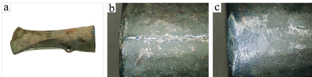
Ryc. 7. Brudzyń (stanowisko 64), pow. żniński. Obraz makroskopowy siekierki tulejkowatej Br_3 (a). Widoczna obrobiona zalewka, powstała w wyniku nieszczelności formy odlewniczej (b). Na kołnierzu zachowane ślady jej eksploatacji (c). Fot. P. Jurecki
