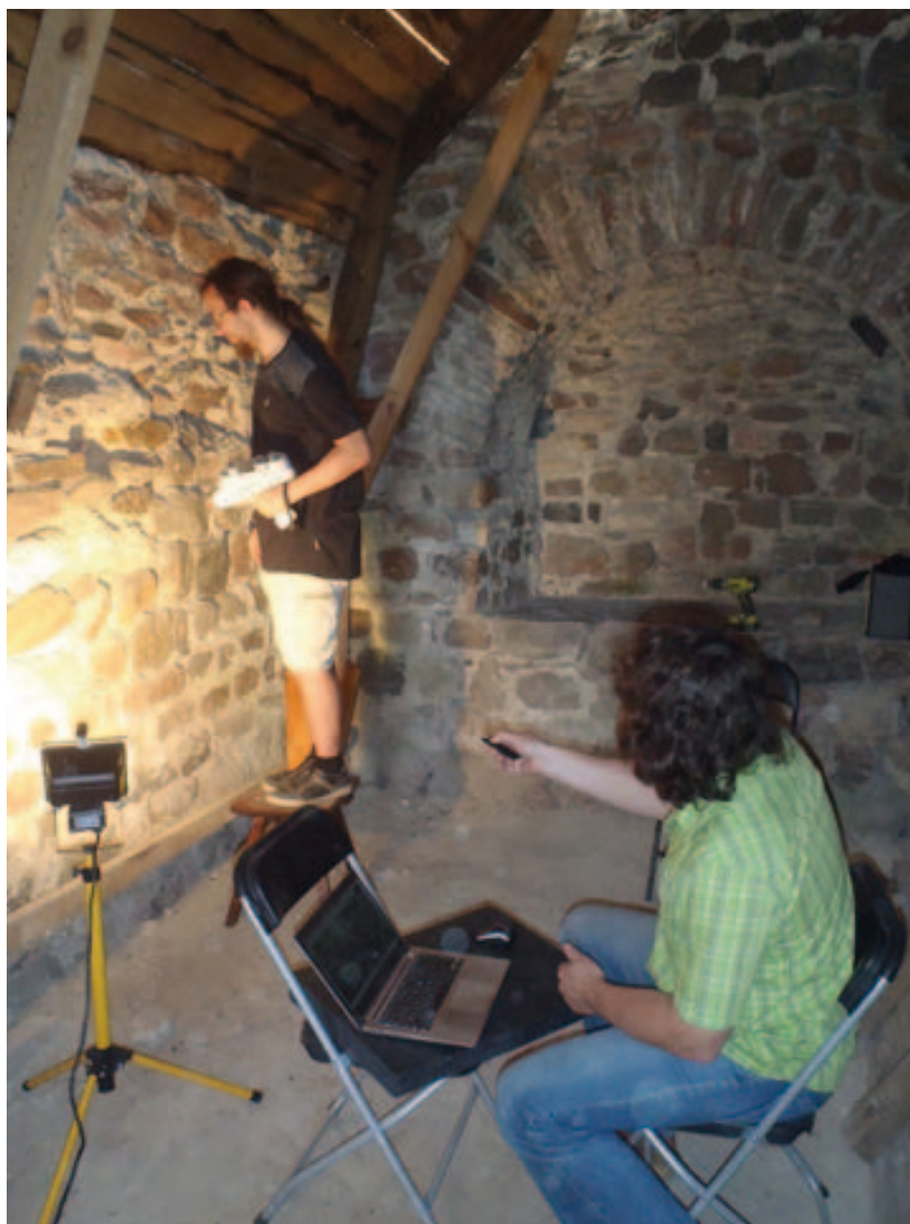
Ryc. 1. Wybór punktów pomiarowych za pomocą ręcznego wskaźnika laserowego na podstawie dokumentacji fotograficznej. Fot. P. Niedzielski
