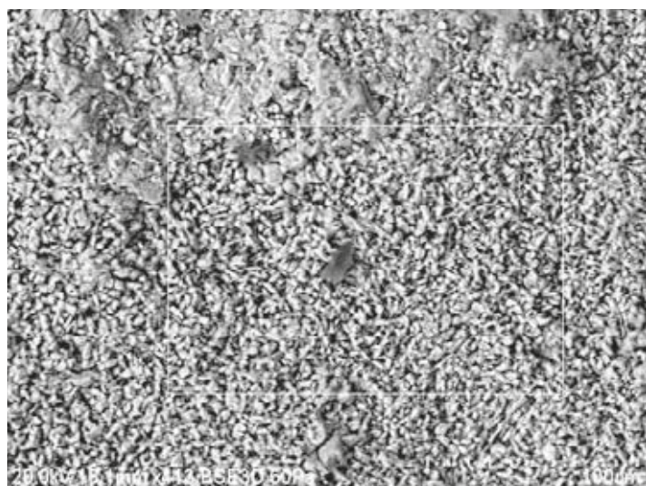
Ryc. 8. Obraz elektronowy podłoża pigmentu (powiększenie 413 x) oraz skład chemiczny obszaru zakreślonego ramką (analiza półilościowa). Fot. J. Michniewicz
