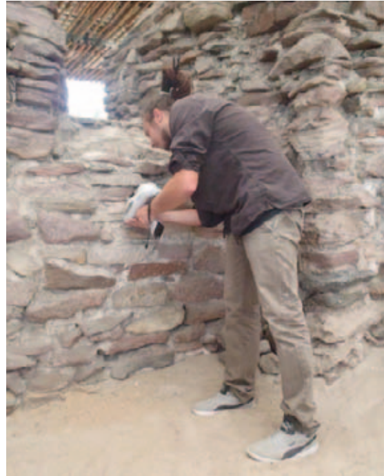
Ryc. 3. Analiza XRF zapraw. Fot. P. Niedzielski Fig. 3. XRF analysis of the mortar. Photo by P. Niedzielski
