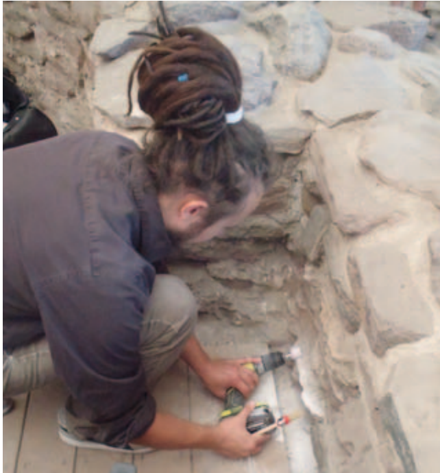
Ryc. 2. Oczyszczanie powierzchni zapraw przed analizą. Fot. P. Niedzielski Fig. 2. Cleaning of the mortar surface before analysis. Photo by P. Niedzielski
