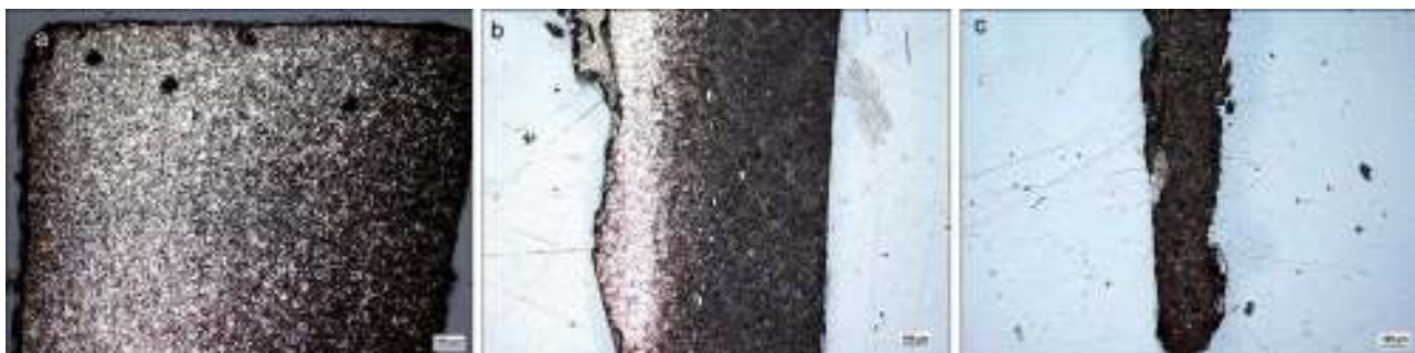
Ryc. 339. Wrocław, pl. Nowy Targ, wykop 2010–2012. Budowa noża nr inw. 542/11, widoczne jest skucie dwu różnych surowców. Fot. B. Miazga
