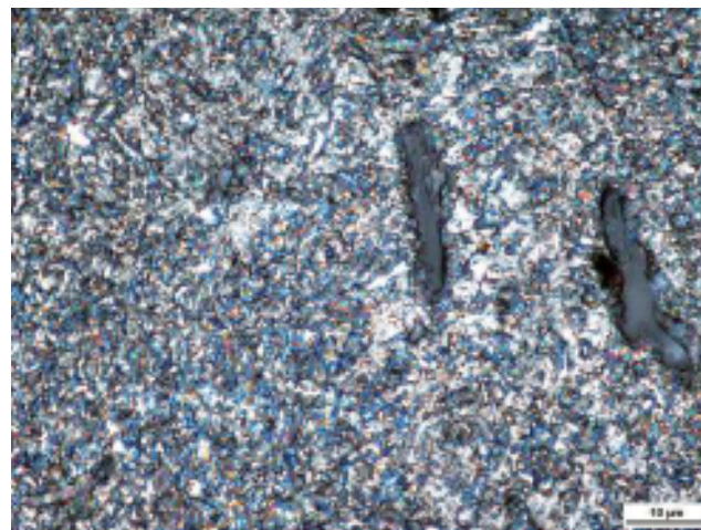
Ryc. 317. Wrocław, pl. Nowy Targ, wykop 2010–2012. Struktura martenzytyczna w ostrzu noża nr inw. 2190/11. Fot. B. Miazga
