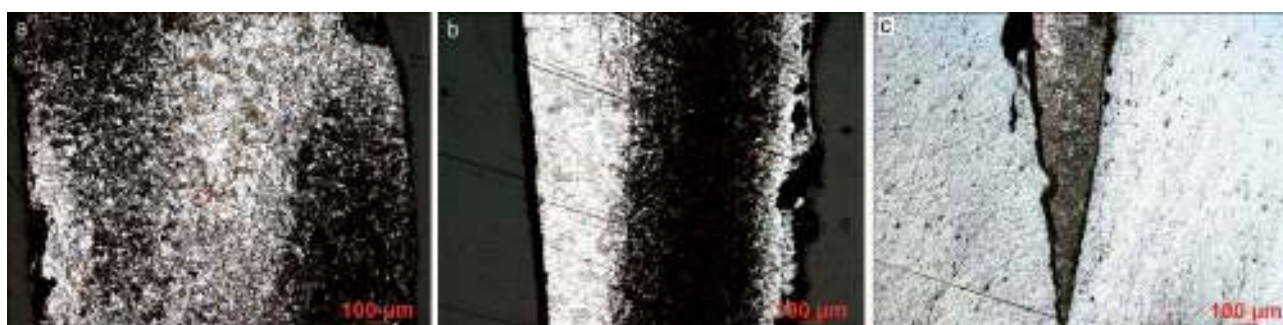
Ryc. 337. Wrocław, pl. Nowy Targ, wykop 2010–2012. Budowa noża A ze zbioru nr inw. 2819/11 z widocznymi połączeniami różnych materiałów. Fot. B. Miazga
