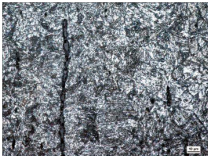
Ryc. 321. Wrocław, pl. Nowy Targ, wykop 2010–2012. Ostrze noża nr inv. 7267/11 z widocznym odpuszczonym martenzytem. Fot. B. Miazga
