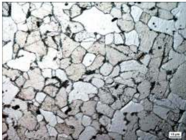
Ryc. 325. Wrocław, pl. Nowy Targ, wykop 2010–2012. Trzpień noża nr inw. 236/10 po trawieniu. Widoczna jest struktura ferrytyczno-perlityczna. Fot. B. Miazga
