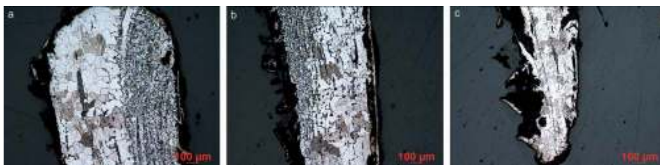
Ryc. 291. Wrocław, pl. Nowy Targ, wykop 2010–2012. Obraz mikroskopowy przekroju poprzecznego noża nr. inw. 2819/11 po trawieniu nitalem 4% tylca (a) i środkowej części (b) o mieszanej strukturze ferrytycznej i ferrytyczno-perlitycznej oraz ostrza, zawierającego duże ziarna ferrytu (c). Fot. B. Miazga
