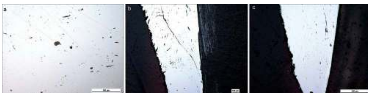
Ryc. 302. Wrocław, pl. Nowy Targ, wykop 2010–2012. Tylec (a), miejsce łączenia (b) oraz ostrze (c) noża nr inw. 9347/11 przed trawieniem. Widoczna osnowa metaliczna z wtrąceniami niemetalicznymi, linie inkluzji w części b wskazują rejon łączenia tylca i ostrza. Fot. B. Miazga
