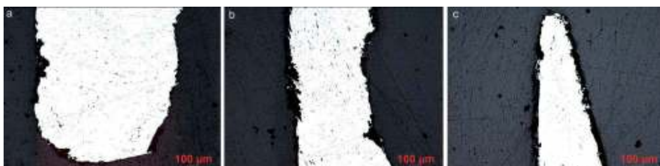
Ryc. 346. Wrocław, pl. Nowy Targ, wykop 2010–2012. Obraz mikroskopowy noża dziwerowego nr inw. 11578/11 z widocznymi licznymi wtrąceniami niemetalicznymi. Fot. B. Miazga Fig. 346. Wrocław, Nowy Targ square, excavations 2010–2012. Pattern welded knife, inv. no. 11578/11. Microscopic view with numerous non-metallic inclusions visible. Phot. B. Miazga
