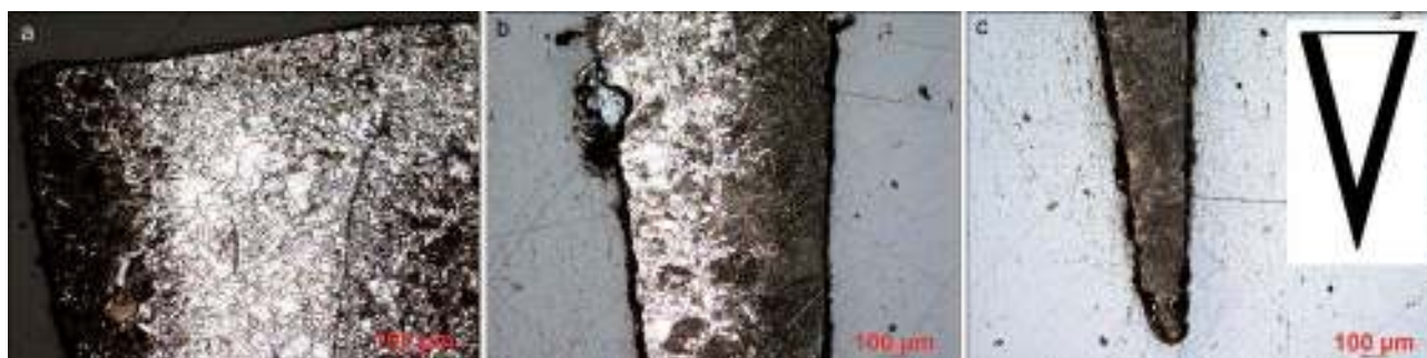
Ryc. 364. Wrocław, pl. Nowy Targ, wykop 2010–2012. Rekonstrukcja budowy noża nr inw. 203/10 wraz ze zdjęciami mikroskopowymi przekroju poprzecznego noża. Widoczne zużycie stalowej okładziny w części środkowej jednego płaza (b) oraz obecność stali na tym płazie w tylcu (a) i ostrzu (c). Fot. B. Miazga
