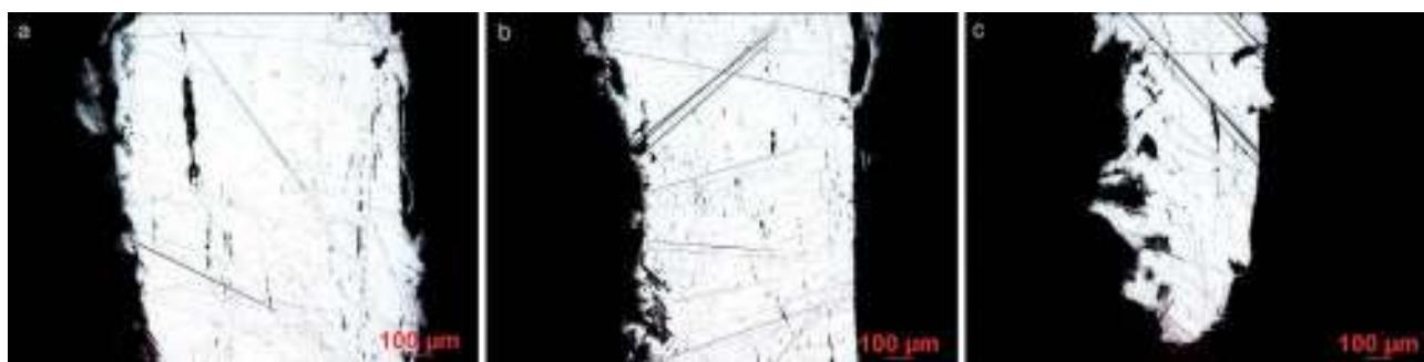
Ryc. 290. Wrocław, pl. Nowy Targ, wykop 2010–2012. Obraz mikroskopowy przekroju poprzecznego noża nr. inw. 2819/11 w stanie nietrawionym dla tylca (a), części środkowej (b) oraz ostrza (c) z widocznymi licznymi wtrąceniami niemetalicznymi. Fot. B. Miazga
