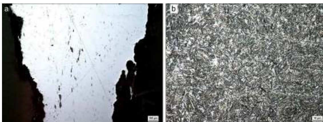
Ryc. 300. Wrocław, pl. Nowy Targ, wykop 2010–2012. Obraz mikroskopowy ostrza noża nr inw. 10403/11 przed trawieniem (a) i po trawieniu (b). Widoczne podłużne wtrącenia niemetaliczne i drobnoiglasta struktura martenzytu. Fot. B. Miazga
