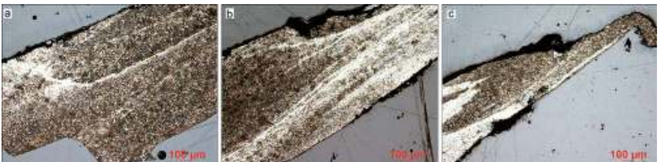
Ryc. 353. Wrocław, pl. Nowy Targ, wykop 2010–2012. Niehomogeniczna budowa noża nr 1 ze zbioru noży nr inw. 3110/11. Fot. B. Miazga
