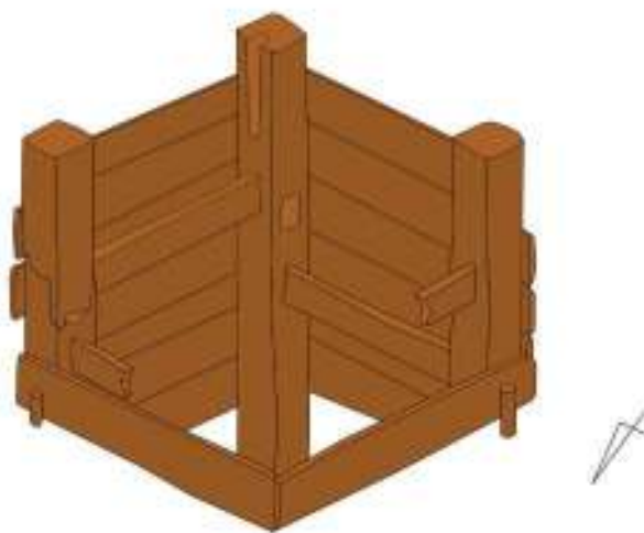
Ryc. 71. Wrocław, pl. Nowy Targ, wykop 2010–2012. Konstrukcja cembrowiny studni js. 478. Oprac. M. Mackiewicz
