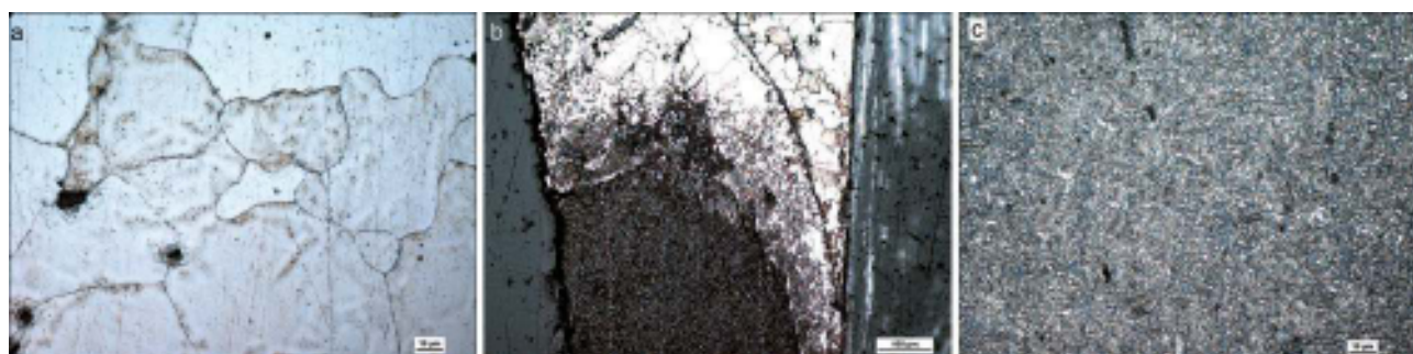
Ryc. 303. Wrocław, pl. Nowy Targ, wykop 2010–2012. Budowa noża nr inw. 9347/11 po trawieniu nitałem. Widoczna odmienna budowa krystaliczna w tylcu i ostrzu noża. Fot. B. Miazga
