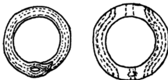
Ryc. 10. Różnice w ułożeniu pasów zanieczyszczeń żużla w pierścieniach wykonanych z drutu ciągniętego i sztancowanych
