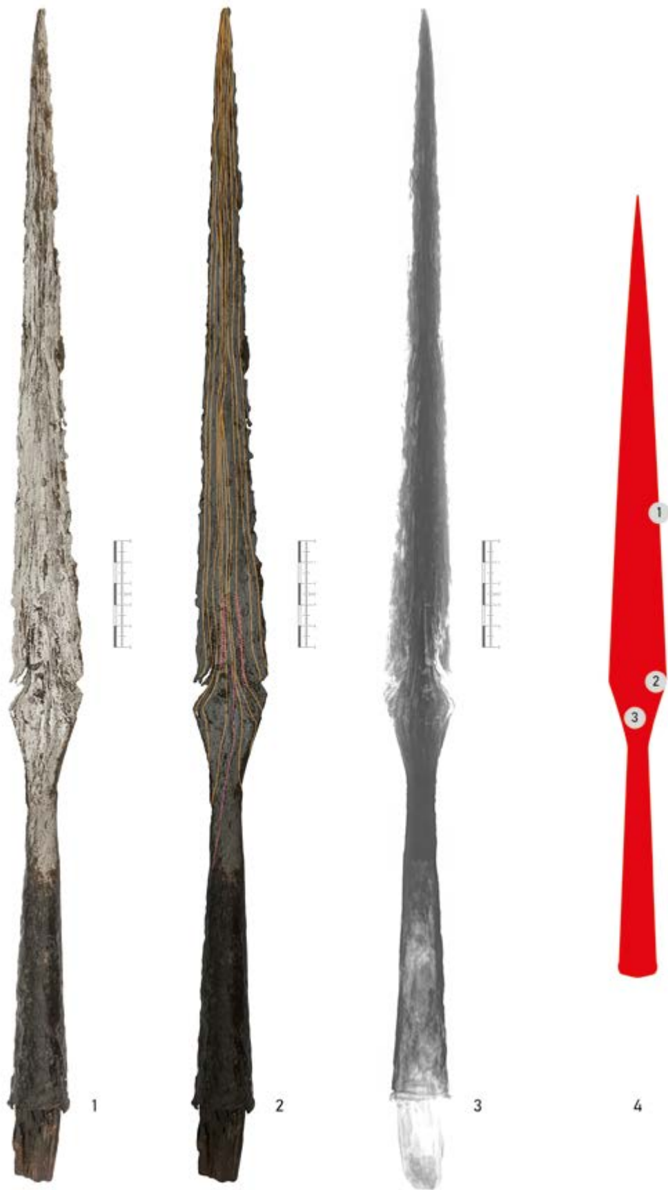
Tablica 10. Grot włóczni, nr kat. 28: 1. wyróżniki korozyjne; 2. zgrzeiny (pomarańczowy — prostopadłe; purpurowy — równoległe); 3. pozytyw rentgenogramu; 4. miejsca wykonania analiz spektralnych (skala dot. 1–3) Plate 10. Spearhead, Cat. No. 28: 1. corrosion indicators; 2. welds (orange — perpendicular; purple — parallel); 3. roentgenogram positive; 4. spectral analysis locations (scale refers to 1–3)
