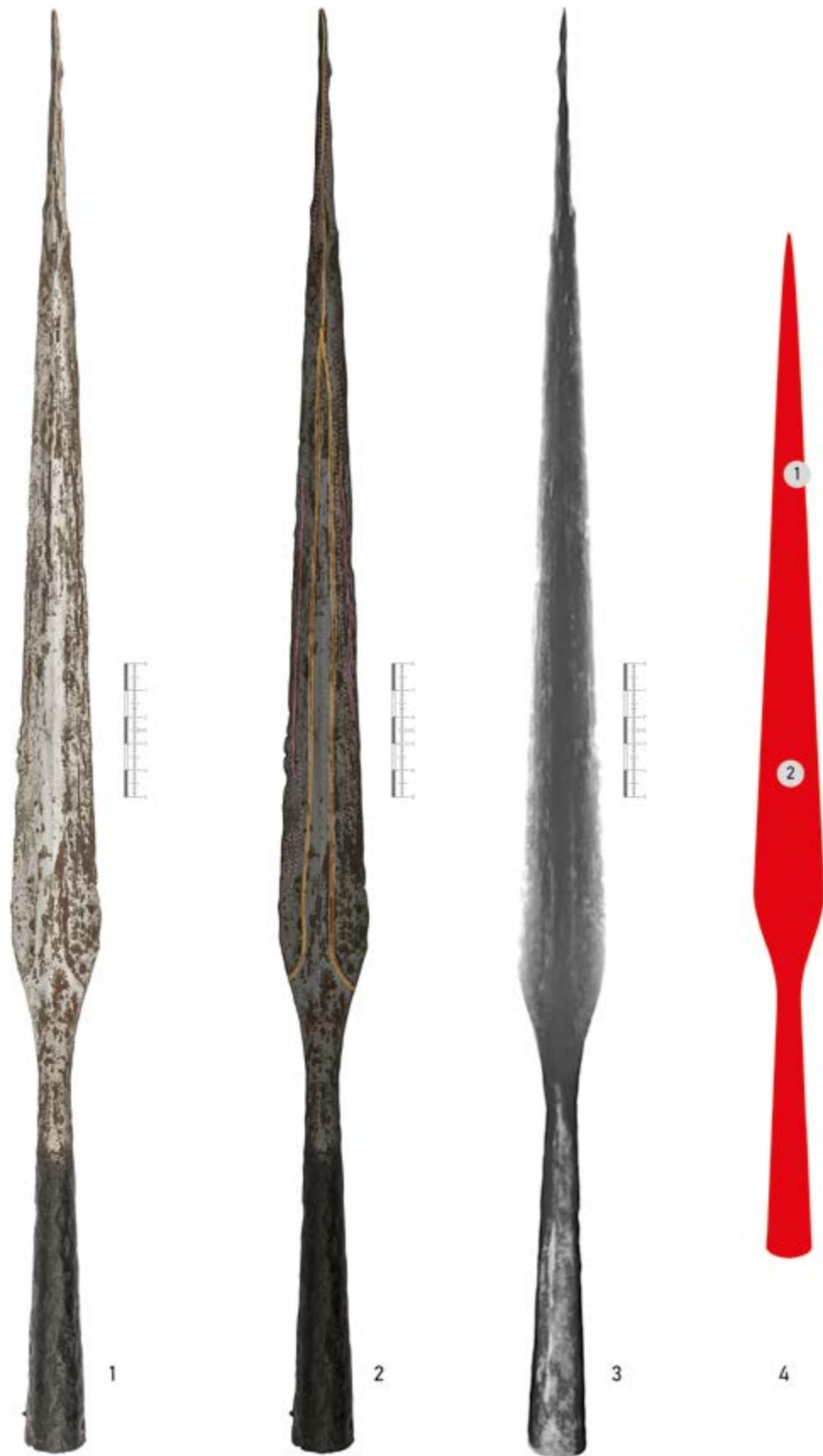
Tablica 13. Grot włóczni, nr kat. 35: 1. wyróżniki korozyjne; 2. zgrzeiny (pomarańczowy — prostopadłe; purpurowy — równoległe); 3. pozytyw rentgenogramu; 4. miejsca wykonania analiz spektralnych (skala dot. 1–3) Plate 13. Spearhead, Cat. No. 35: 1. corrosion indicators; 2. welds (orange — perpendicular; purple — parallel); 3. roentgenogram positive; 4. spectral analysis locations (scale refers to 1–3)
