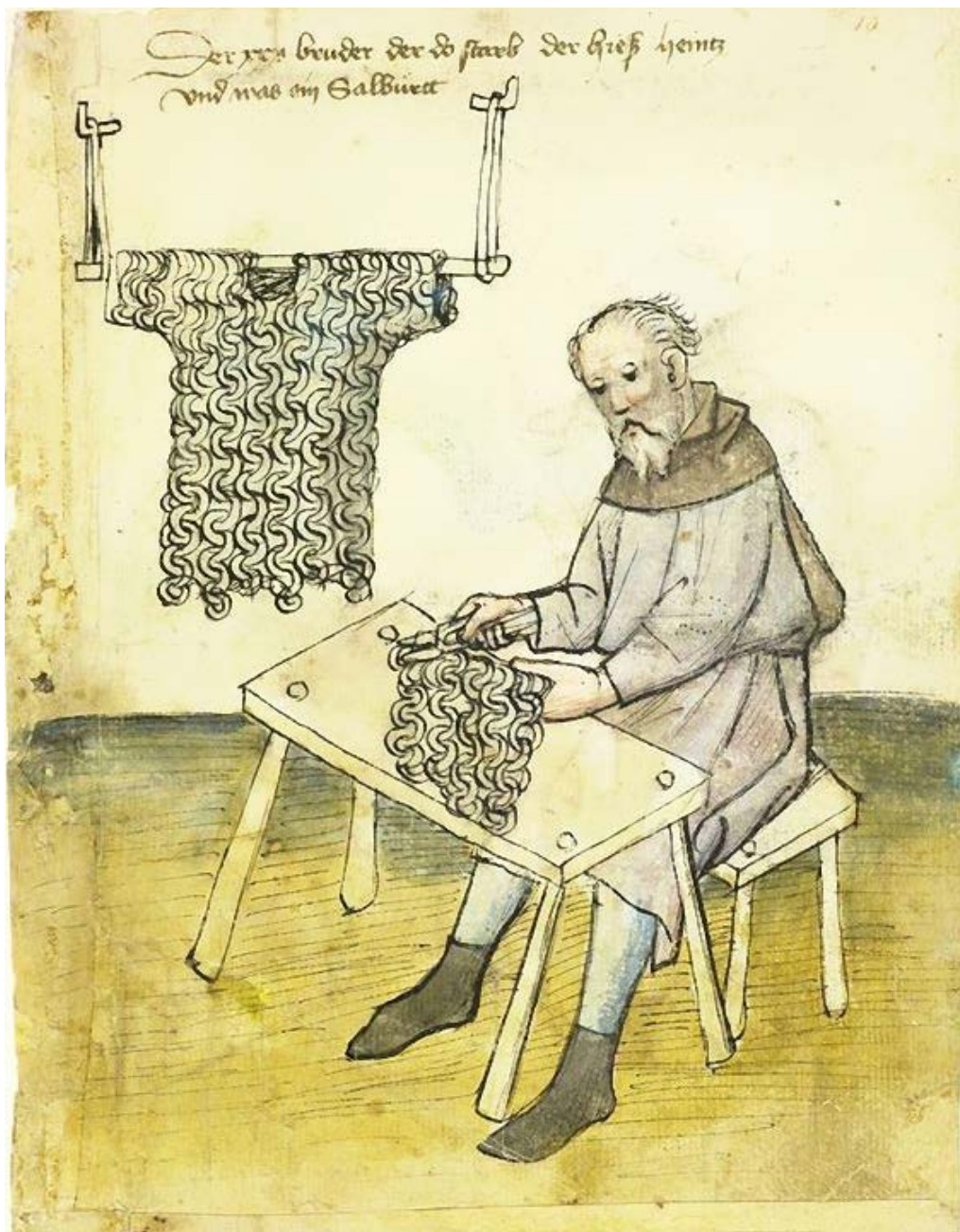
Ryc. 4. Rzemieślnik (pancernik) wytwarzający plecionkę kolczą. Gotowa kolczuga wisi przymocowana do ściany ( Hausbücher der Nürnberger Zwölfbrüderstiftungen )
