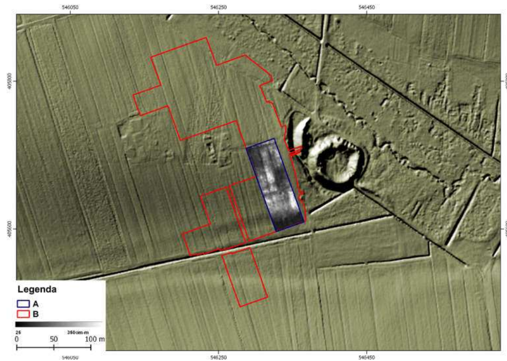
Ryc. 4.61. Rękoraj. Wizualizacja danych elektrooporowych w skali szarości nałożona na cieniowany relief terenu. A. Obszar objęty pomiarami magnetycznymi 2013; B. Obszar objęty pomiarami elektrooporowymi 2013
