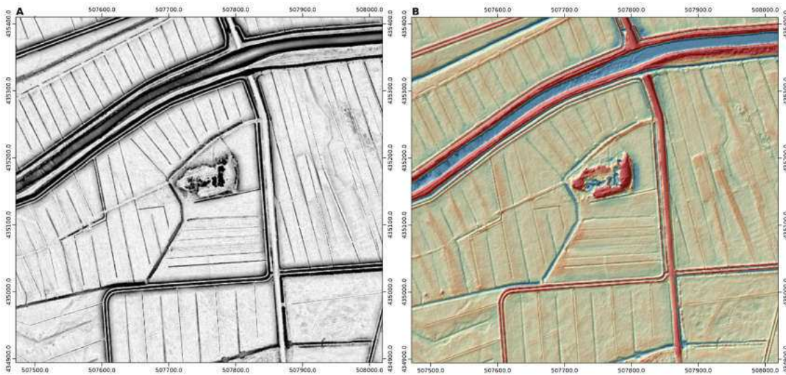
Ryc. 4.123. Szydłów. Wizualizacje NMT z pomiarów ALS z programu ISOK. A. Sky View Factor; B. Local Dominance
