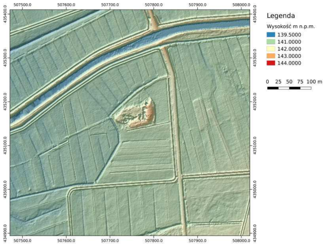
Ryc. 4.122. Szydłów. Wizualizacja NMT (cieniowanie zboczy, Hz – 315^{\circ} ; Vt – 45^{\circ} ) z pomiarów ALS z programu ISOK
