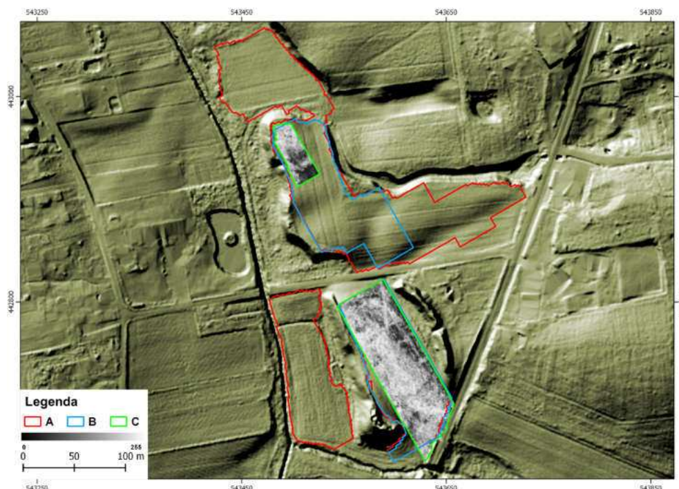
Ryc. 4.114. Stare Skoszewy. Wizualizacja danych radarowych (ciąćcie czasowe 23-29 ns) w skali szarości nałożona na cieniowany relief terenu. A. Obszar objęty pomiarami magnetycznymi 2013 i 2016; B. Obszar objęty pomiarami elektrooporowymi 2016; C. Obszar objęty pomiarami georadarowymi 2016
