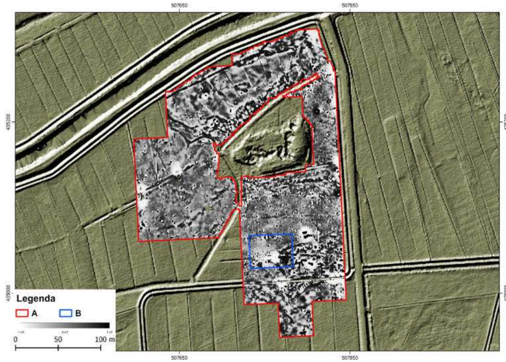
Ryc. 4.124. Szydłów. Wizualizacja danych magnetycznych w skali szarości nałożona na cieniowany relief terenu. A. Obszar objęty pomiarami magnetycznymi; B. Obszar objęty pomiarami elektrooporowymi
