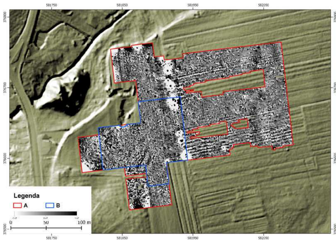
Ryc. 4.145. Żarnów. Wizualizacja danych magnetycznych w skali szarości nałożona na cieniowany relief terenu. A. Obszar objęty pomiarami magnetycznymi; B. Obszar objęty pomiarami elektrooporowymi
