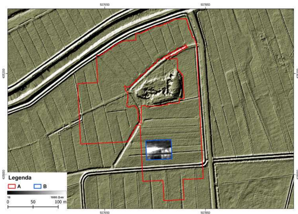
Ryc. 4.125. Szydłów. Wizualizacja danych elektrooporowych w skali szarości nałożona na cieniowany relief terenu. A. Obszar objęty pomiarami magnetycznymi; B. Obszar objęty pomiarami elektrooporowymi
