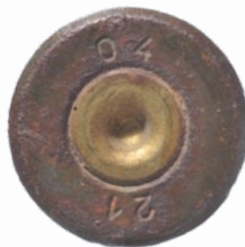
Ryc. 15. Dno łuski naboju „ślepego” kalibru 7,62 × 39 mm, z widocznym oznaczeniem fabrycznym (nr inw. 161/4). Fot. M. Kowalewski.
