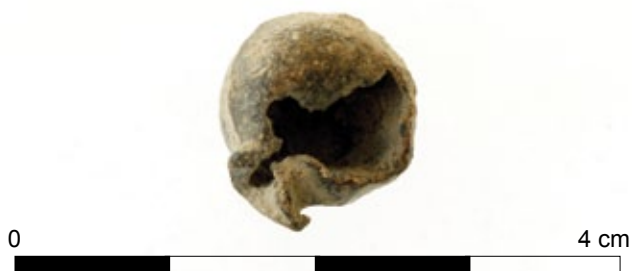
Ryc. 4. Kula wadliwie odlana z „pustką powietrzną” (nr inw. pol. 157/10). Fot. M. Gorzkowska.
