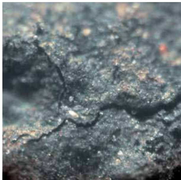
Ryc. 10. Silnie popękana powierzchnia substancji organicznej — próbka Sr 811 (polaryzacyjny mikroskop optyczny PZO, powiększenie 120 ×)
