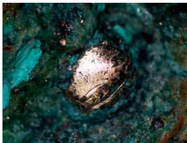
Ryc. 31. Fragment tygla (próbka nr 657) z widoczną kroplą brązu, powiększenie 50×
