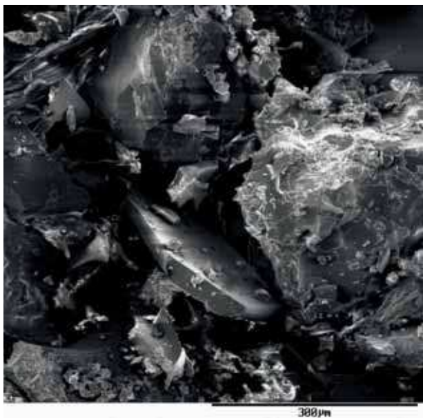
Ryc. 9. Polimerowa struktura materiału smolistego — próbka Sr 171 (skaningowy mikroskop elektronowy SEM, powiększenie 200 ×)
