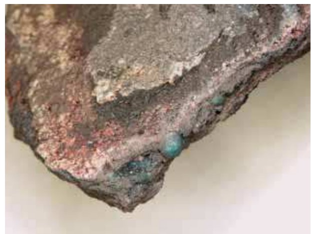
Ryc. 39. Fragment tygla (próbka nr 656) z widocznymi kropkami stopu
