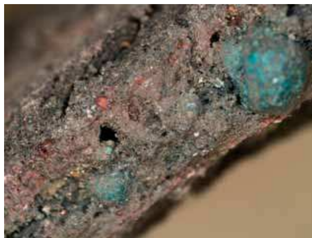
Ryc. 40. Fragment tygla (próbka nr 656) z widocznymi kroplami stopu, powiększenie 20×
