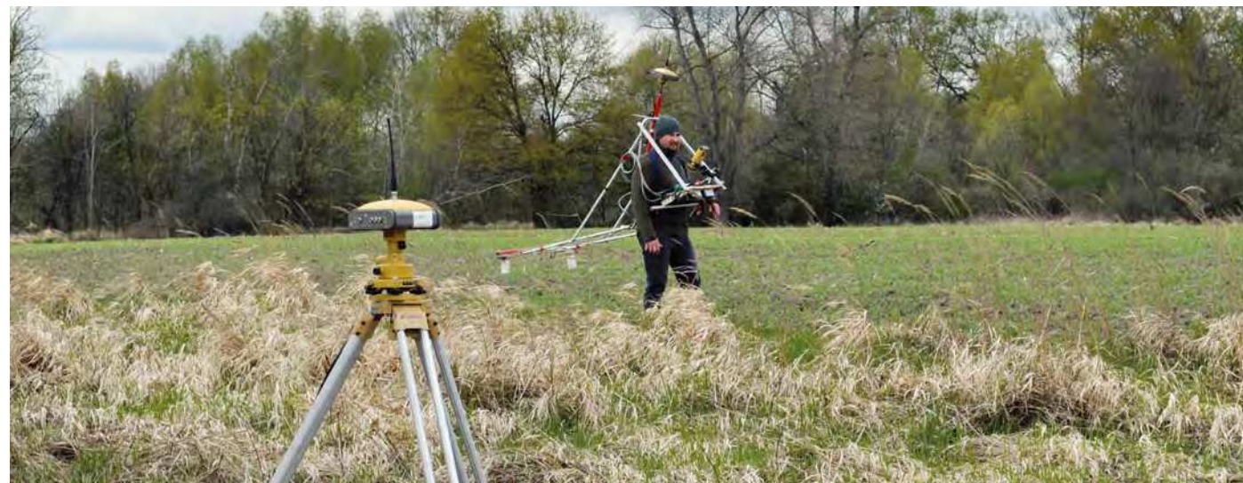
Pomiary magnetometrem cezowym. Na pierwszym planie widoczna jest stacja georeferencyjna (fot. G. Kiarszys)
