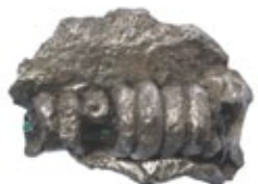
Fot. 2. Obiekt nr inw. 70 z fragmentem zachowanej sprężyny wykonanej ze stopu srebra z żelazem, fot. M. Gładki
