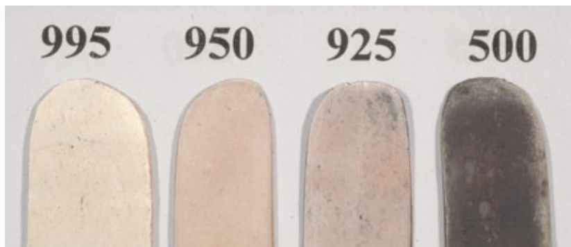
Fot. 1. Wzorcowe blaszki z przykładami prób stopów srebra, fot. J. Strobin
