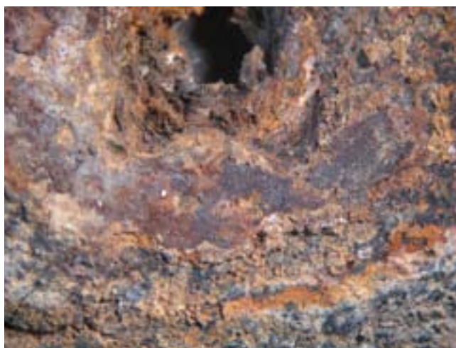
Ryc. 8. Ślady po produktach korozji żelaza na elementach skórzanych, zdjęcie wykonane pod mikroskopem. Fot. D. Grupa.
