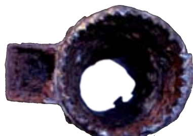
Ryc. 18. Korpus rozerwanej rakiety. Obraz od strony zapala. Reduta Ordon – zbiory prywatne. Fot. P. Wilczyński.
