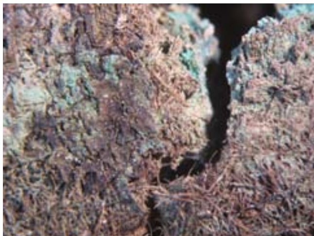
Ryc. 9. Tkanina wełniana przesiąknięta produktami korozji z mosiężnego guzika – zielone zabarwienie. Fot. D. Grupa.
