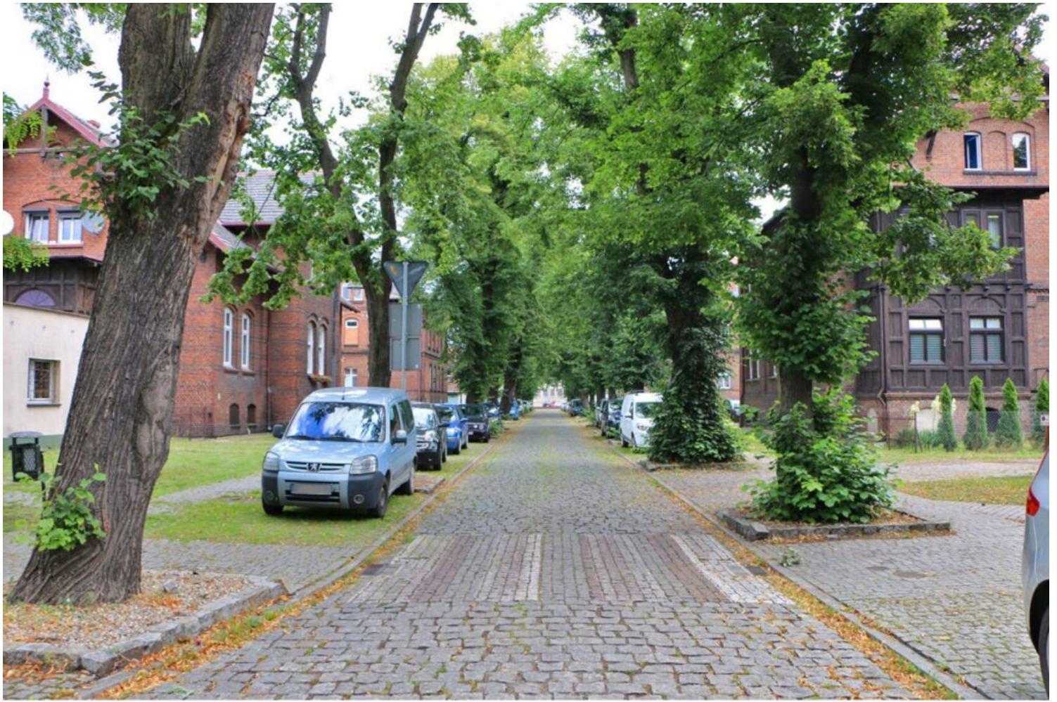
Zbąszyń, rynek. Drzewa w chodniku kolidują z ruchem pieszym, pozostawiono zbyt małe misy wokół pni, fot. R. Banach, 2012
