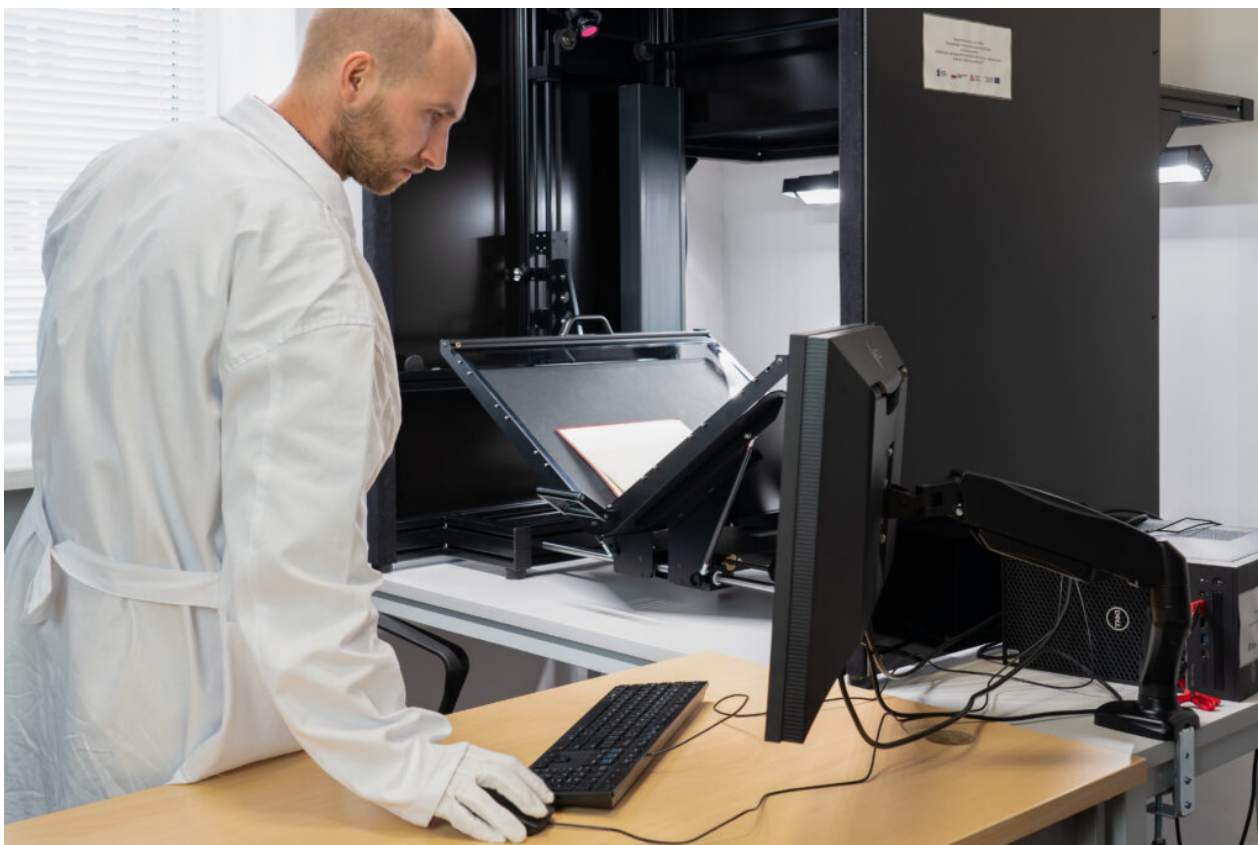
Skaner V-kształtny do digitalizacji poszytów i wrażliwych na rozkładanie materiałów, fot. NID/Tobiasz Bułynko
